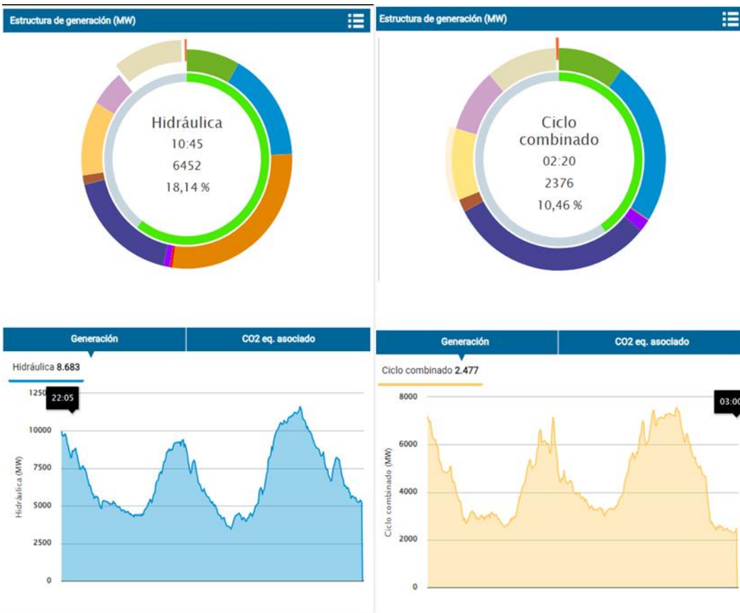
Ilustración 21. Generación en el sistema peninsular de España de las tecnologías “Hidráulica” y “Ciclo combinado” durante las 24 horas del 25 de enero de 2024 en el soporte de la carga variable.
