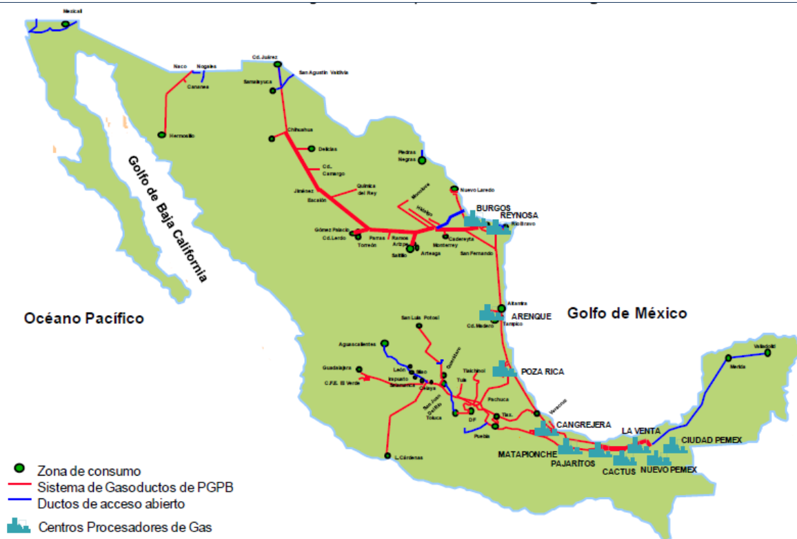
Figura A-5 COBERTURA DE RED DE GASODUCTOS
