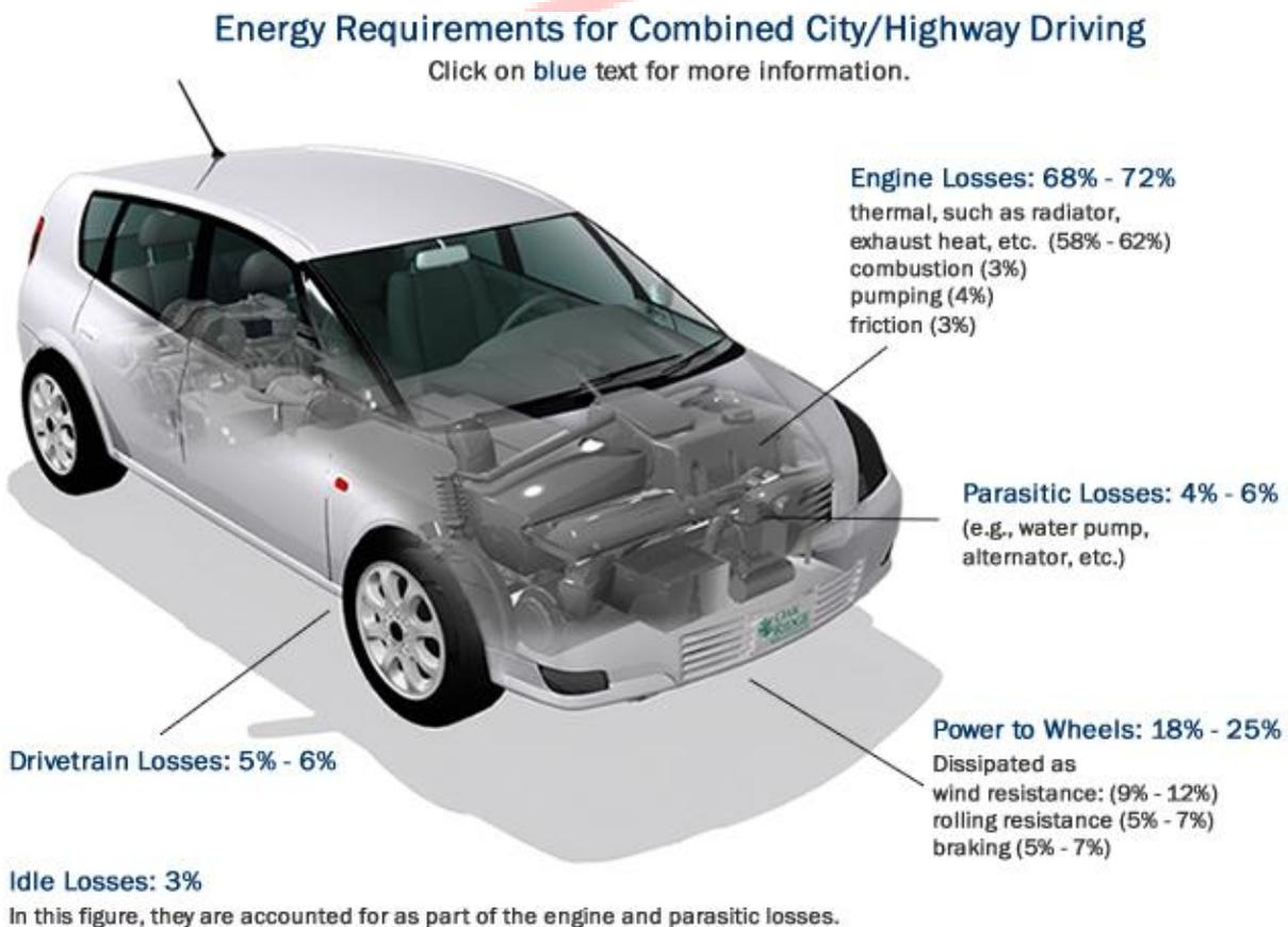
Ilustración 1. Requerimientos de energía para vehículos de gasolina en conducción combinada ciudad-carretera<sup>3</sup>.
